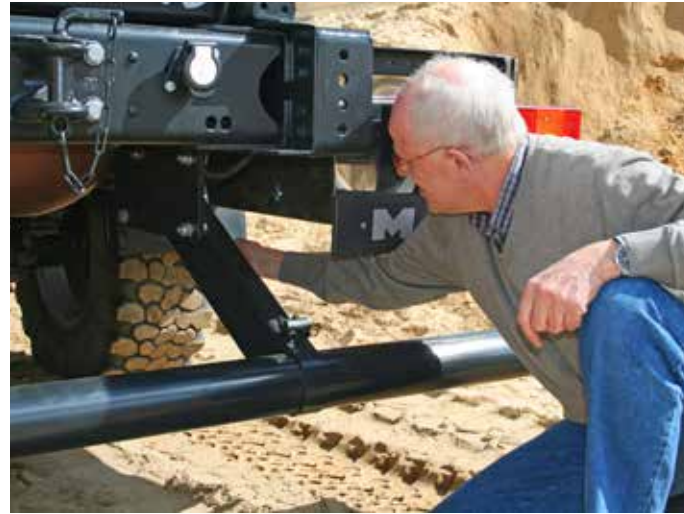
Offroad-optimiert: Der Auffahrtschutz ist in Europa Pflicht. Ist man im harten Gelände unterwegs, kann man ihn mit einem Handgriff hochklappen.
