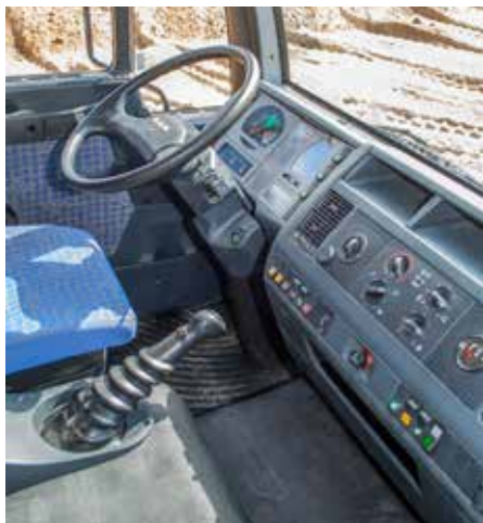
Komfortabel: Die gefederte Kabine ist mit ihren Schwingsitzen absolut langstreckentauglich. Die Differentialsperren sowie das Untersetzungsgetriebe lassen sich einfach per Knopfdruck aktivieren.
