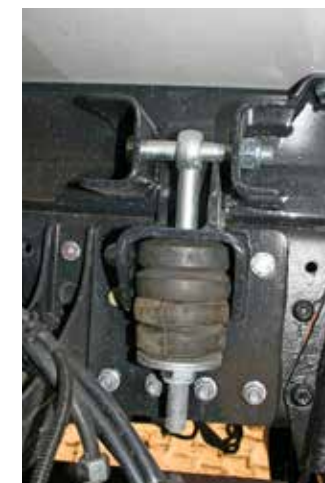
Ausgeklügelt: Bei Verwindung wird das Gummilager komprimiert. Das Fahrverhalten ist sehr stabil.
