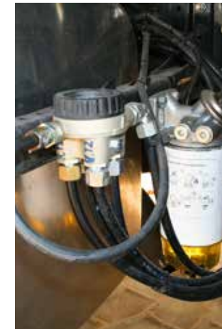
Solide Technik: Die Umschaltung der beiden Tanks erfolgt manuell. Der Dieselfilter ist beheizt.
