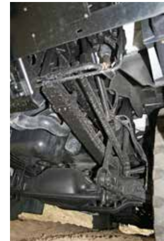
Einfach und haltbar: Das Parabelfeder-Fahrwerk ist überraschend komfortabel abgestimmt.
