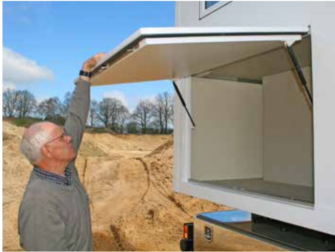
Bestens verarbeitet: Die großen Stauklappen besitzen die gleiche Materialstärke wie die 60-Millimeter-Außenwand.
