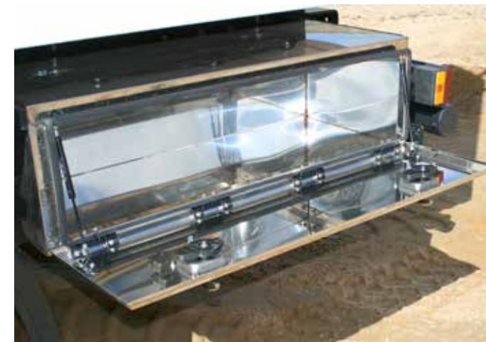
Optimal genutzt: Den Platz am Unterboden füllt Kerkamm mit wasser- und staubdichten Staubboxen. Bodenfreiheit geht dadurch nicht verloren.
