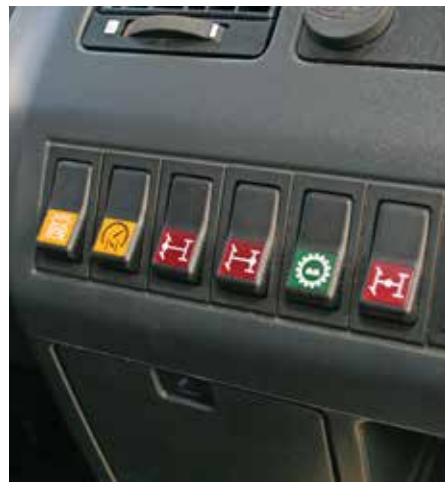
Komfortabel: Die gefederte Kabine ist mit ihren Schwingsitzen absolut langstreckentauglich. Die Differentialsperren sowie das Untersetzungsgetriebe lassen sich einfach per Knopfdruck aktivieren.
